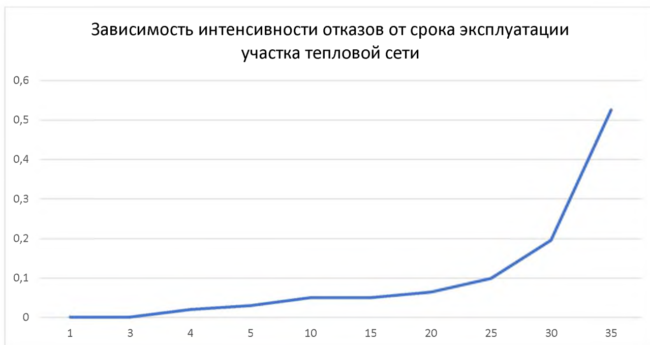
Рисунок 11.7.1.1 – Зависимости интенсивности отказов от срока эксплуатации участка тепловой сети.
