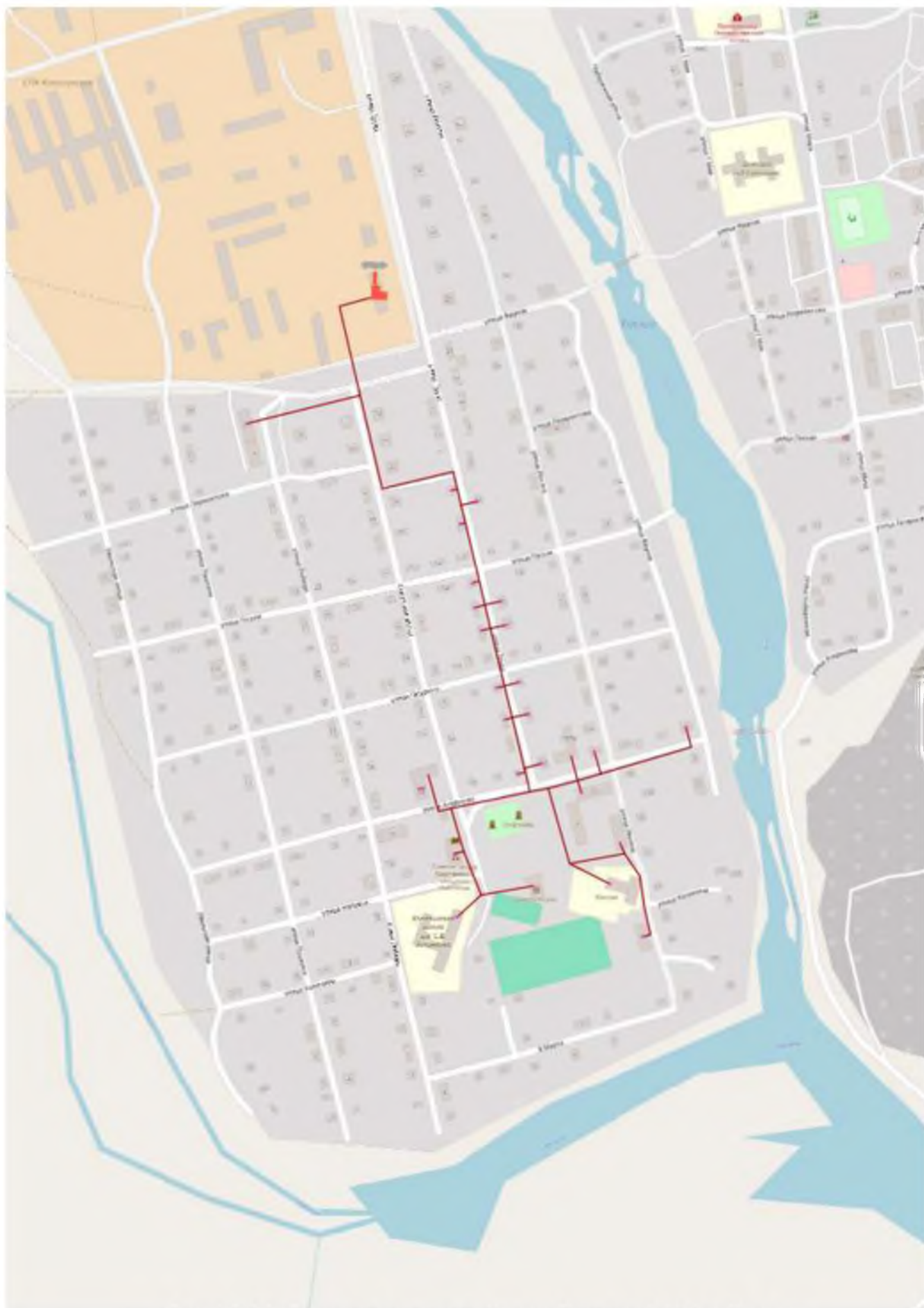
Рис. 1.3.2.3. Схема тепловых сетей от от Котельной № 1 с. Коелга
