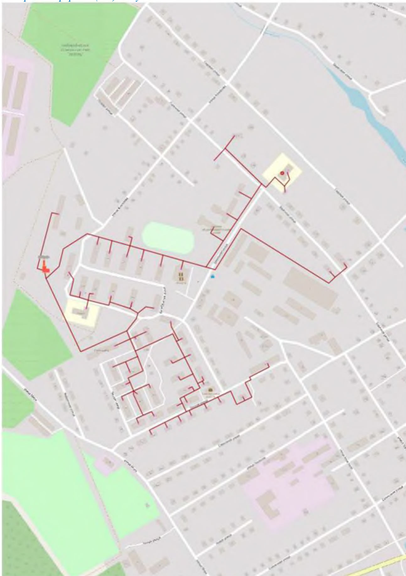
Рис. 1.3.2.1. Схема тепловых сетей от Котельной с. Еманжелинка
