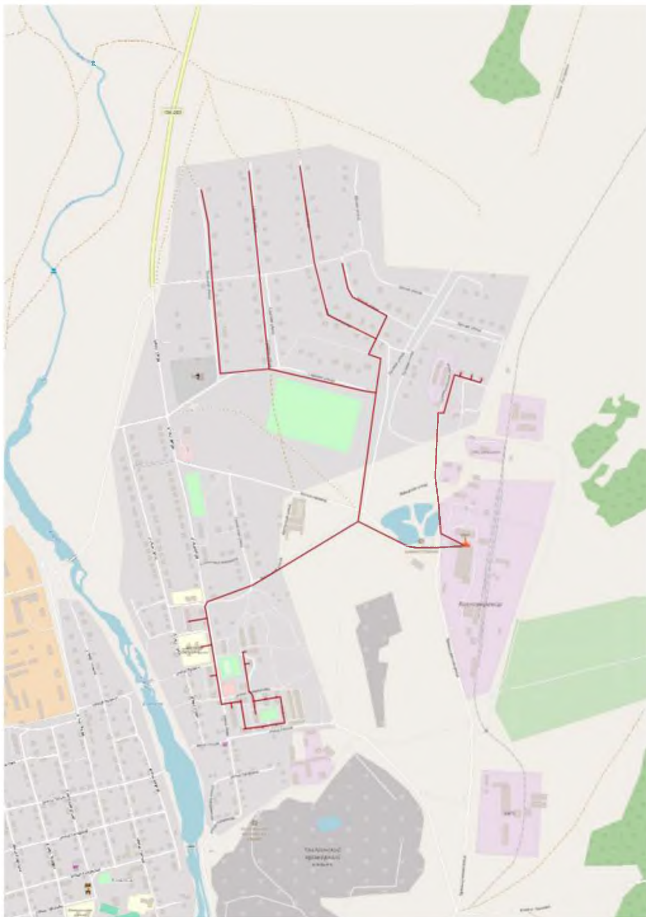
Рис. 1.3.2.4. Схема тепловых сетей от Котельной № 2 с. Коелга
